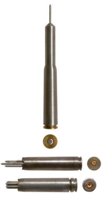
Fig. 28-20. 1.5mm Lancejet cartridges. Actual size.
